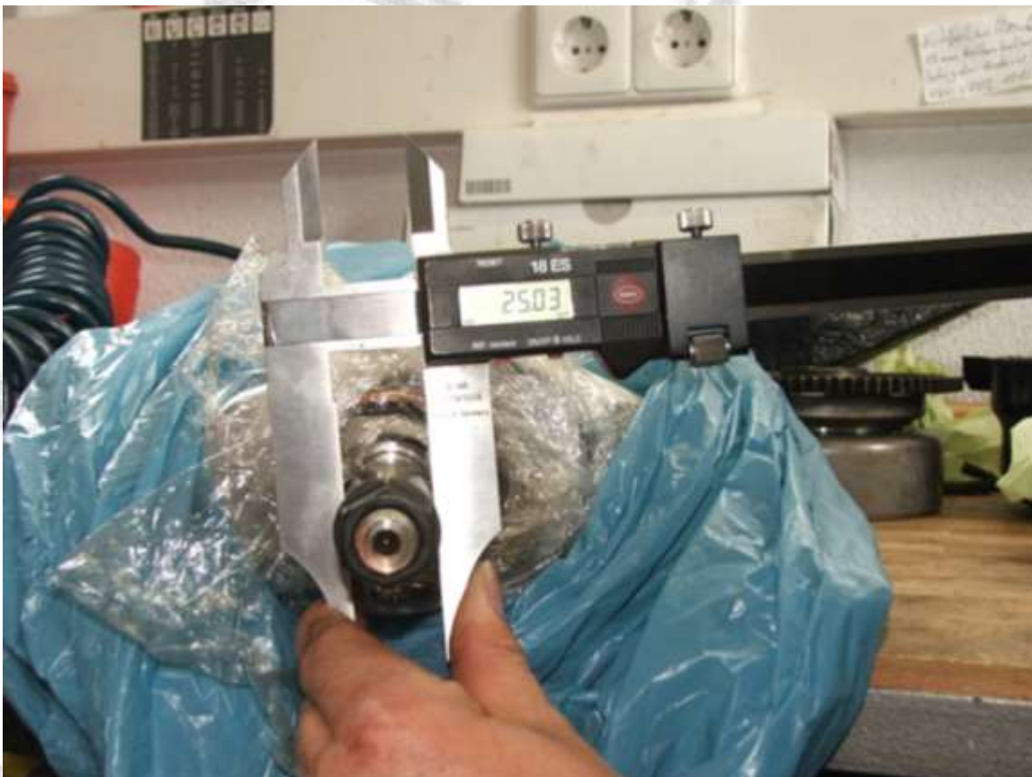
Im Vergleich die Kurbelwelle der GS110X/U701/U702 (nur silber)-Motoren mit ca. 25 mm Durchmesser!
