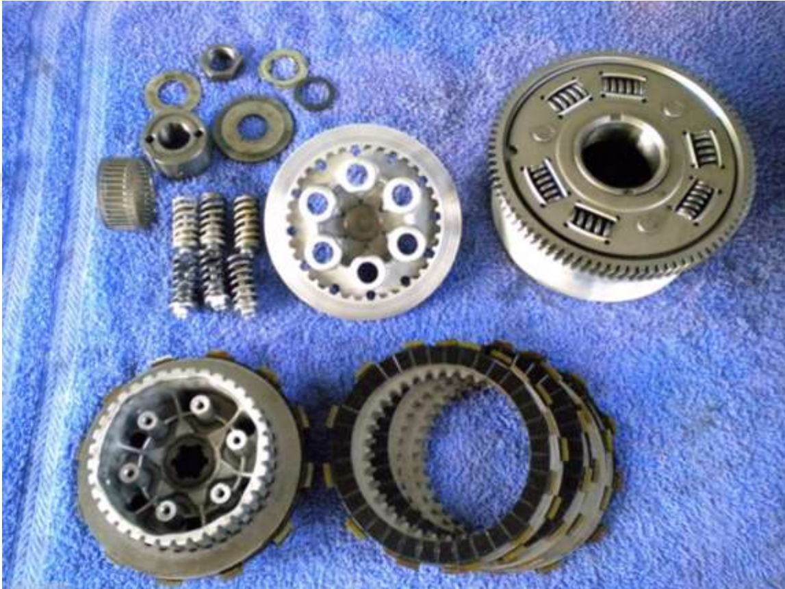
Im Bild oben alle Teile der Kupplung
