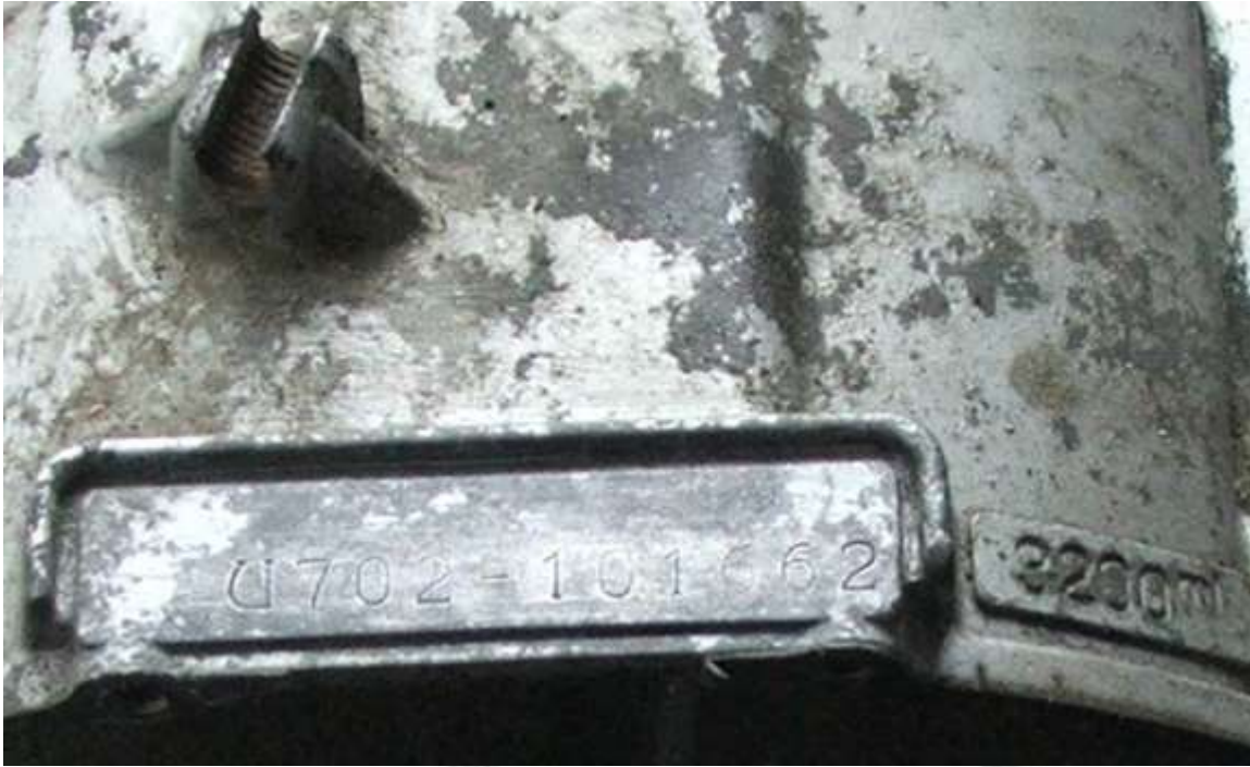
U702 – in silber (!) – 18 mm Kolbenbolzen – Pleuel 492 – Kurbelwelle NICHT verschleißt!
