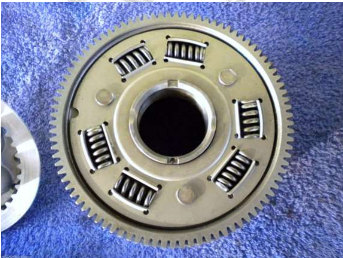
Diese sechs Federn im Bild oben können sich setzen bzw. brechen. Hier gibt es Ersatz, u.a. von APE
