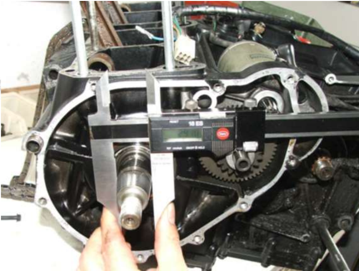
Im Bild oben – Big End mit ca. 29 mm Durchmesser.
