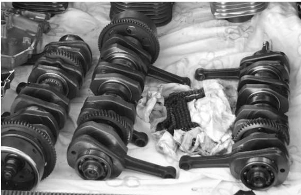
GS110X – serienmässig nur verpresst, schräg verzahnt
